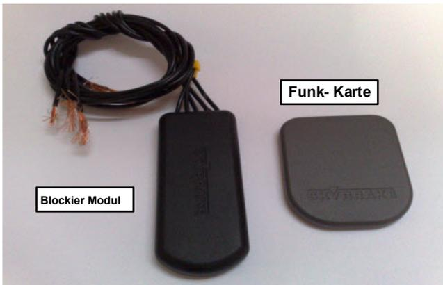
Mit der **SB 2** besitzen Sie eine Wegfahrsperre, die trotz einfacher Bedienung (tastenloser Funkbefehl), Ihr Fahrzeug vor einer unerlaubten Nutzung schützt.
