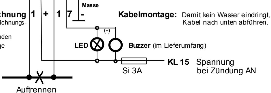
— Fahrzeugleitung, die durch die Wegfahrsperr im Diebstahl Versuch bei Zündung AN unterbrochen wird. z.B. Anlasserrelais- Ansteuerung.
